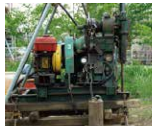
【ボーリング調査】
