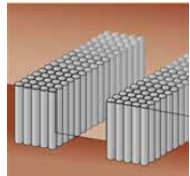
【山留め・止水壁】
