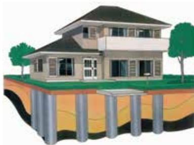
グリーンコラム工法は、ミルク状にしたグリーンドロコン0を攪拌し、柱状で強固な改良コラムを造る『六価クロム非溶出型地盤改良工法』です。
